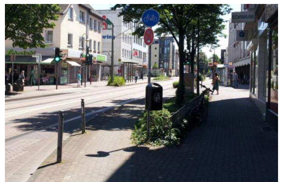
Abbildung 83: Engstelle für den Radverkehr durch Verschwenkung, Poller und Schild an der Friedrich-Ebert-Straße, zu schmaler Radweg
