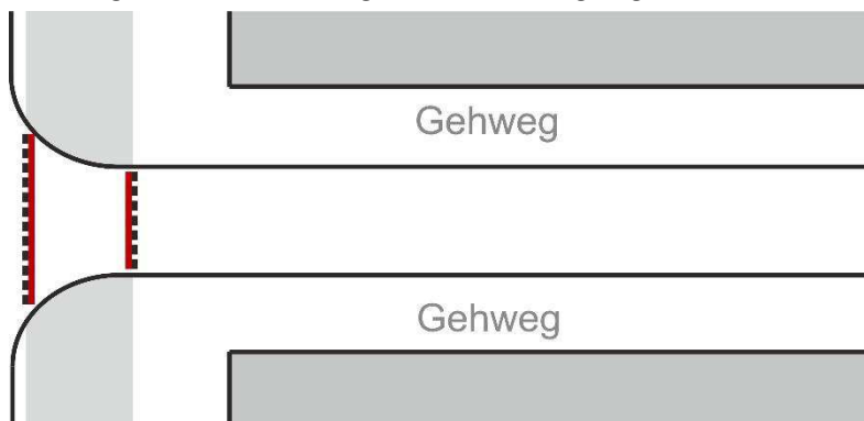
Abbildung 138: Furtmarkierung mit einem durchgezogenen Beistrich
